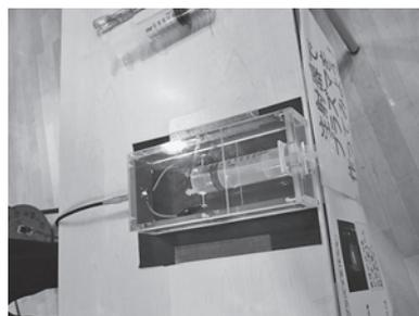
図2 注射器火花放電装置。
