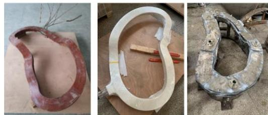
3)1回目VPI後 4)対地絶縁処理 5)2回目VPI(準備時)
