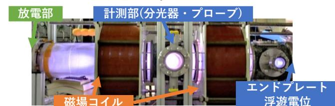
図2: CTP装置におけるRF印加時の水素プラズマ放電の様子 (4.5kW 計測部0.04 T)
