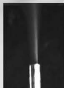
アルミナ(0.1 \mu\text{m} ) 約4 g/min
