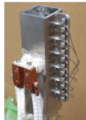
図-2：電極及び熱電対列付き液体流動実験用液体金属容器。
