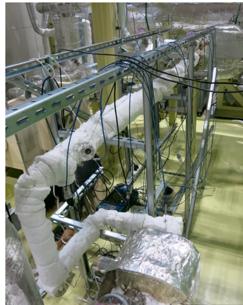
図3：PbLi用の超音波流速計流路試験部
