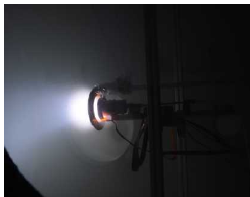
図3 LaB6 熱陰極を用いたプラズマ生成の撮像
