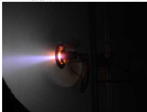
図4 磁気ノズル動作中の撮像
