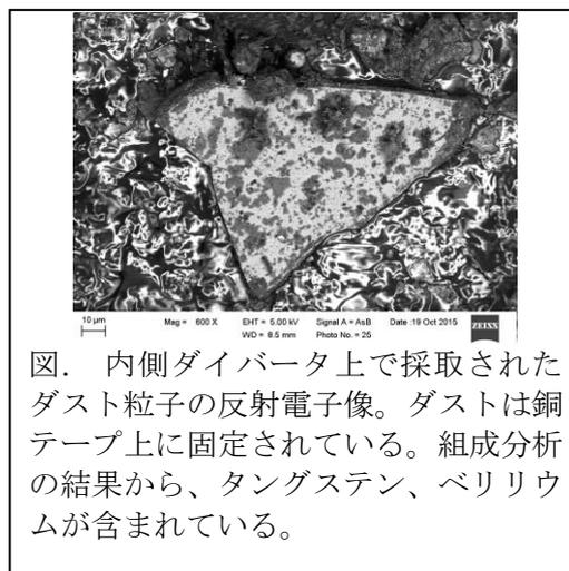
図. 内側ダイバータ上で採取されたダスト粒子の反射電子像。ダストは銅テープ上に固定されている。組成分析の結果から、タングステン、ベリリウムが含まれている。
