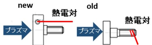
図2: 熱電対の取り付け位置の模式図
