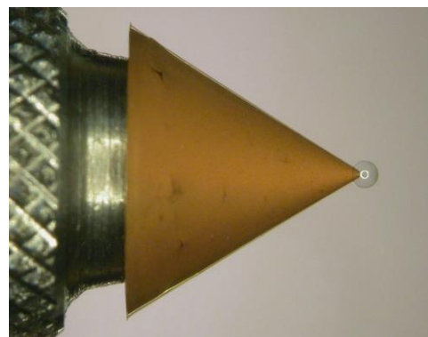
図 2 回収用ターゲットセル
