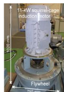
図1 フライホイール付誘導発電機の外観写真
