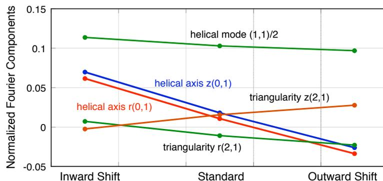
上の図は、LHD実験で用いられる典型的な磁場配位である、内寄せ配位( $R_{ax}=3.6m$ )、標準配位( $R_{ax}=3.75m$ )、外寄せ配位( $R_{ax}=3.9m$ )の真空磁場配位を構成する基本的なフーリエモードを示す。実際には、ここに示す少数のフーリエモードのみによって構成した磁場配位によって、三種の磁場配位の物理的な特長はほぼ完璧に再現される。逆の言い方をすれば、これらの基本モードがLHD装置の磁場配位の物理的特長のほとんどを決定しているとも言える。
