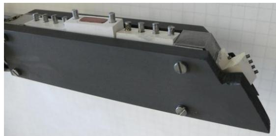
Fig. 1 Radial array probe
