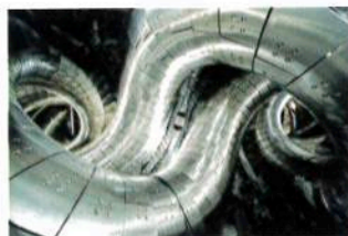
LHDのプラズマ真空容器内部 核融合科学研究所提供
