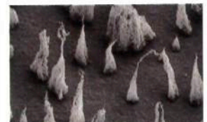
ヘリウム照射で形成される特異なタングステン表面ナノ構造 名古屋大学提供
