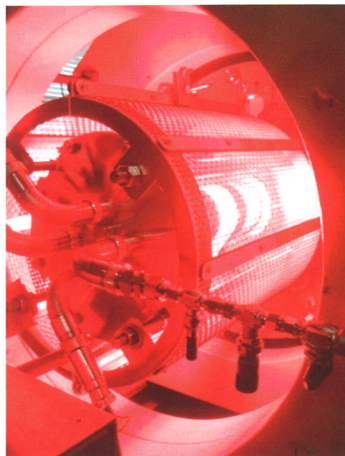
高密度ヘリコンプラズマ装置LMD: ネオンプラズマ 東京農工大学提供
