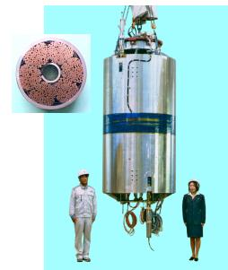
トロイダルコイルセグメント製作(JJ1 and SS316LN)
