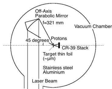
Fig.1. Experimental apparatus
