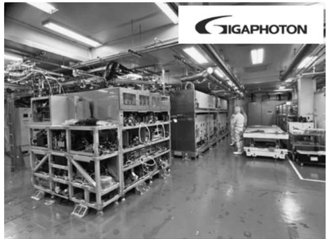
図2 LPP型EUV光源装置(ギガフォトン社提供)。
