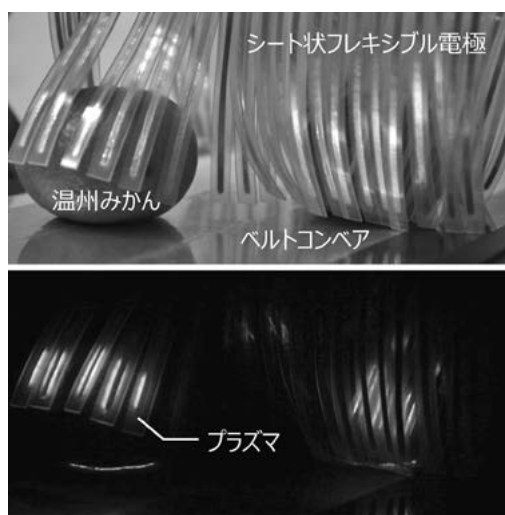
(b) シート状フレキシブル電極により温州みかん果皮に生成したプラズマの様子。
