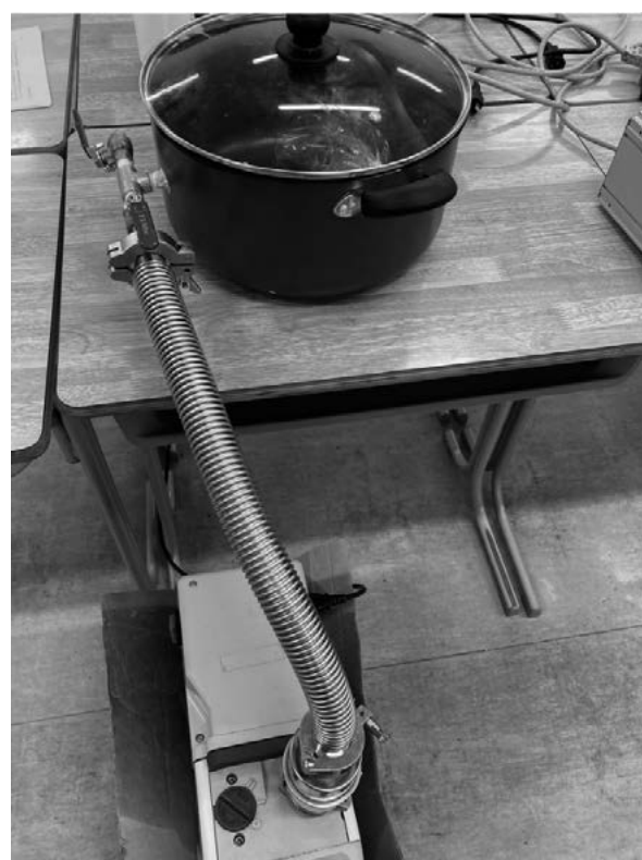
図9 ステンレス鍋に穴あけ加工し、真空配管を接続した様子。
