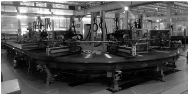
図8 导体絶縁中のITER TF 导体。絶縁装置は导体を徐々に持ち上げる部分、絶縁施工を行う部分、持ち上げた导体を徐々に下す部分に分けられる。これらの部分は連動してRP上を移動する。
