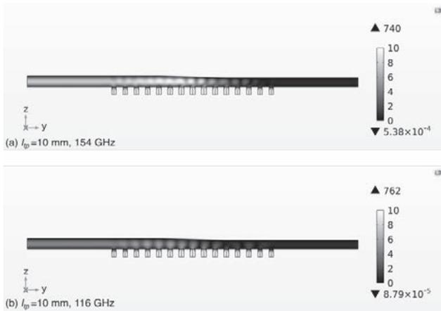
図7 進行波検出ポート側の長辺を 1.651 mm 及び反射波検出ポート側の長辺を 1.377 mm, テーパー長さ 10 mm としたテーパー矩形副導波管モデルにおける導波管中心断面上での (a) 154 GHz のマイクロ波の電場強度の絶対値及び (b) 116 GHz のマイクロ波の電場強度の絶対値の空間分布。
