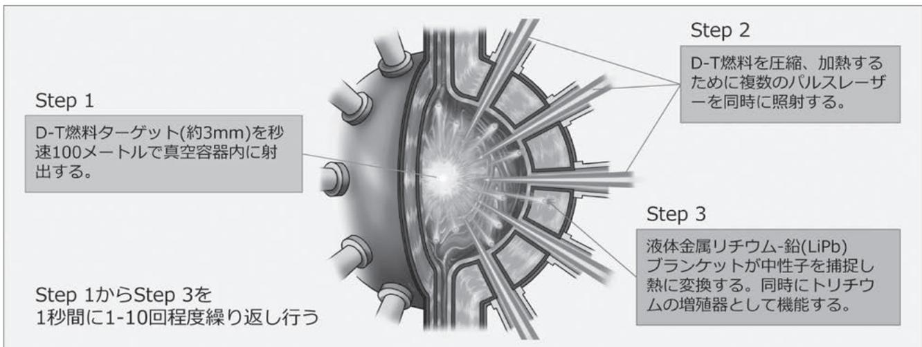
図1 レーザーフュージョンの仕組み。
