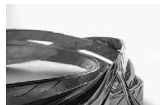
図1 CERNにおいて素粒子加速器のダイポールマグネット用に開発されたRoebel導体[5]。
