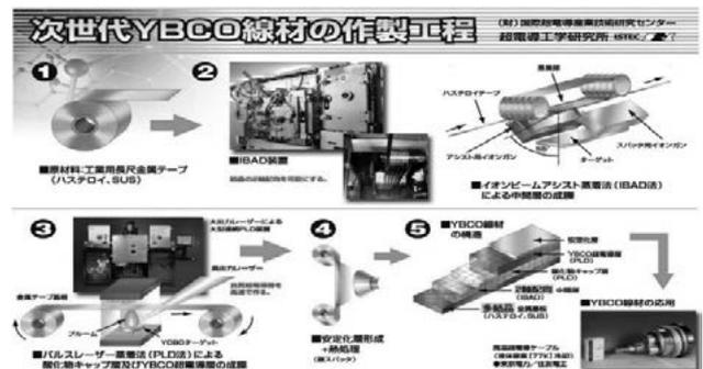
図8 IBAD-PLD法REBCO線材の一貫作製工程 (ISTEC資料から) (ISTEC転載許可. <http://www.istec.or.jp/istec/map&contact.html>).
