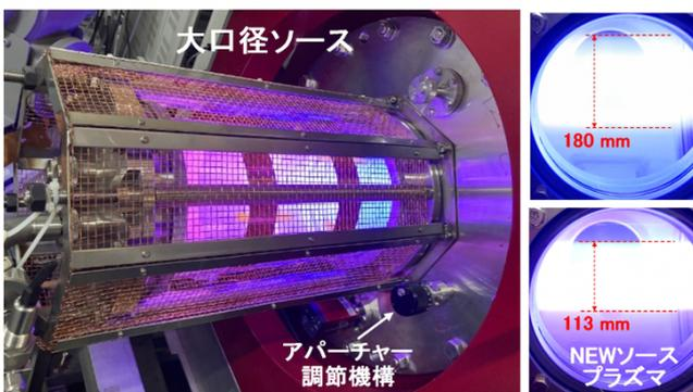
図7 新しいプラズマ源(右)と開口部サイズの変化による実際のプラズマ放電(左)。
