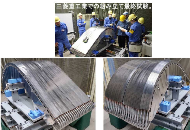
図2 完成したITER外側垂直ターゲット（OVT）実規模プロトタイプ。
