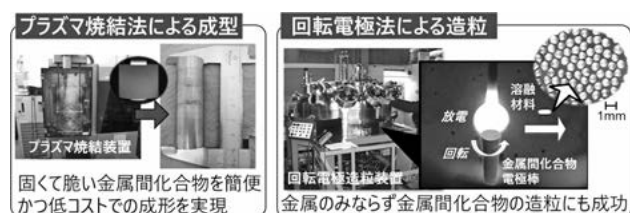
図2 QSTで確立したベリリウム金属及びベリライドの合成及び成形加工技術。
