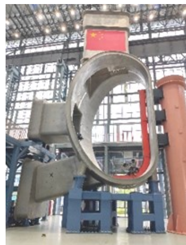
図3 CFETR真空容器の実寸大モックアップ。
