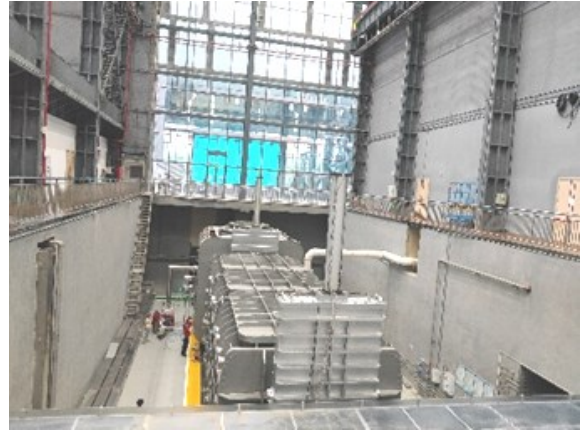
図 4 CFETR 用中性粒子ビームのイオン源 R&D 装置。
