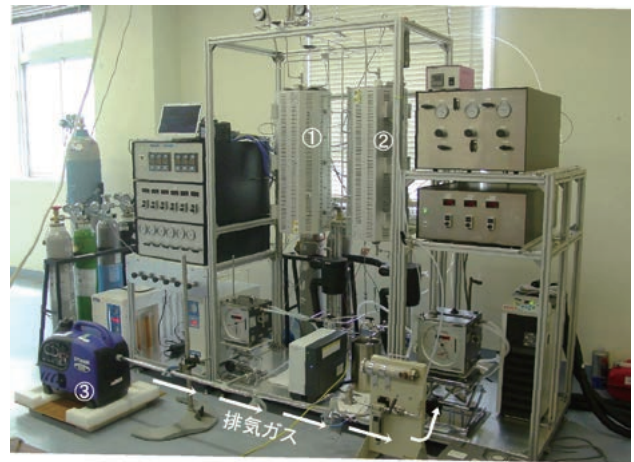
① 第一段反応器 ② 第二段反応器 ③ 小型発電機(50 c.c.)
