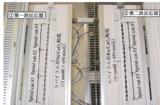
図9 メタン化装置内に設置したスパイラル形構造体触媒。
