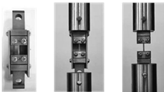
図 2 微小引張試験の様子.
