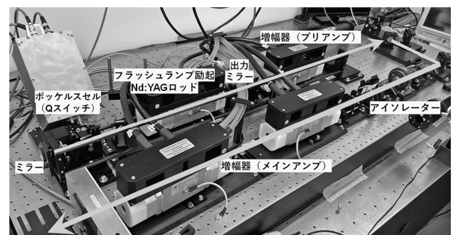
図9 核融合科学研究所・安原氏の開発した高繰り返しで高出力なNd:YAGレーザーの外観.
