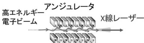
図 1 X 線自由電子レーザーの発生原理.
