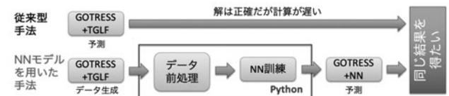
図4 GOTRESSによってNN代理モデルを構築し、温度の定常分布を予測する流れ図。NN代理モデルは図1に示すモデルと同様の構造である。
