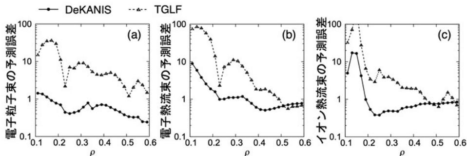
図2 テスト用の14のJT-60UHモードプラズマに対してDeKANISとTGLFを用いて(a)電子粒子束及び(b)電子・(c)イオン熱流束を予測したときの予測誤差(二乗平均平方根誤差 $\sigma$ )の径方向分布。
