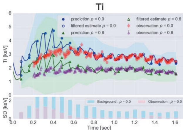
図6 回帰モデルを用いたイオン温度のデータ同化結果.
