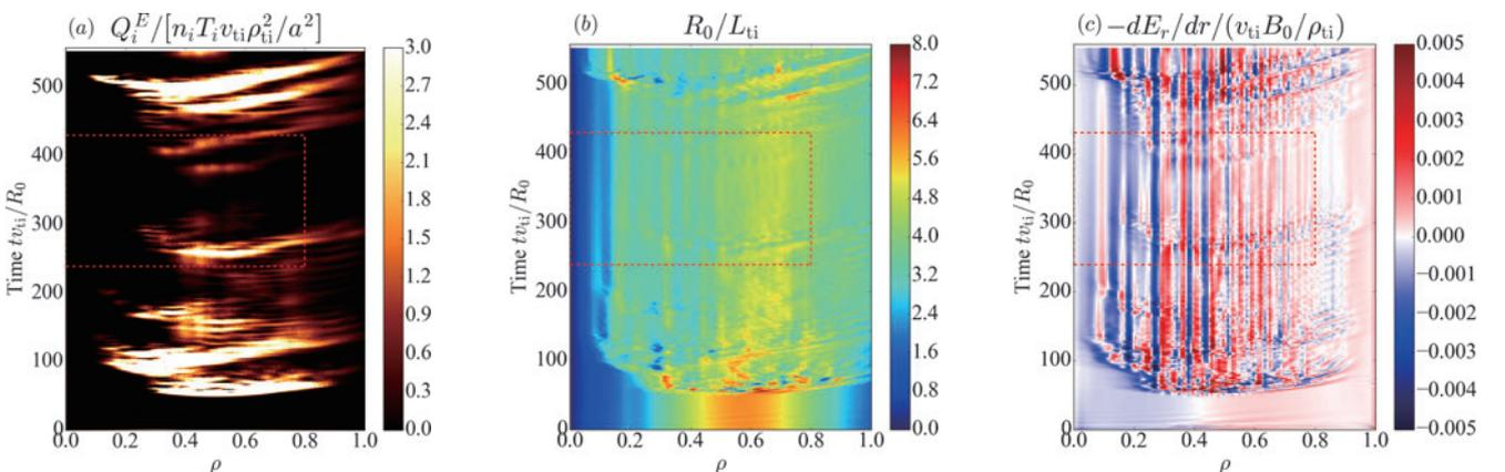
図1 (a)乱流エネルギーフラックス  $Q_i^E$ , (b)規格化イオン温度勾配  $R_0/L_{ti}$ , (c)径電場シア  $dE_r/dr$  の時系列データ。5.4節では赤い点線に囲まれた部分について解析を行った[7]。
