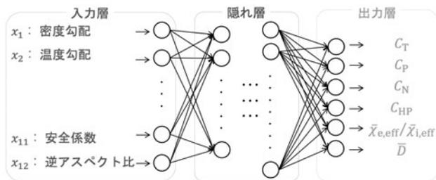
図1 DeKANISが用いるNNモデルの構造。出力された変数から電子粒子束及び電子・イオン熱流束が得られる。
