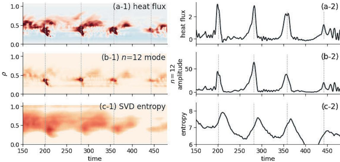
図4 (a-1)熱流束の時空間分布, (b-1)  $n=12$ モード強度の時空間分布, (c-1)SVDを元にした擬エントロピーの時空間分布. (a-2), (b-2), (c-2)にはそれぞれ,  $\rho=0.4$ の位置での時間発展を示す.
