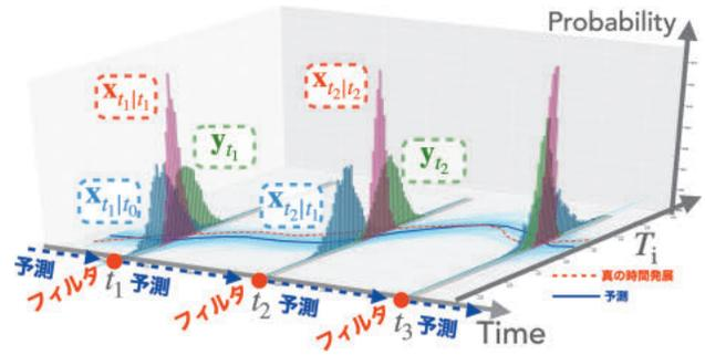
図1 逐次ベイズフィルタの概略図 (イオン温度  $T_i$  での例)。
