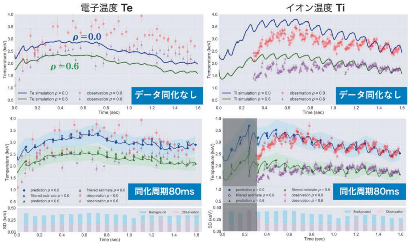
図3 EnKFによる温度の予測結果(上段: TASK3Dのみ, 下段: 80ms おきにデータ同化)。規格化小半径  $\rho = 0.0$  と  $0.6$  について示す。下の棒グラフは、 $\rho = 0.0$  における背景誤差と観測ノイズの標準偏差を表す。また、イオン温度の灰色のハッチは、観測データが無いため、代わりに電子温度を同化させた部分である。
