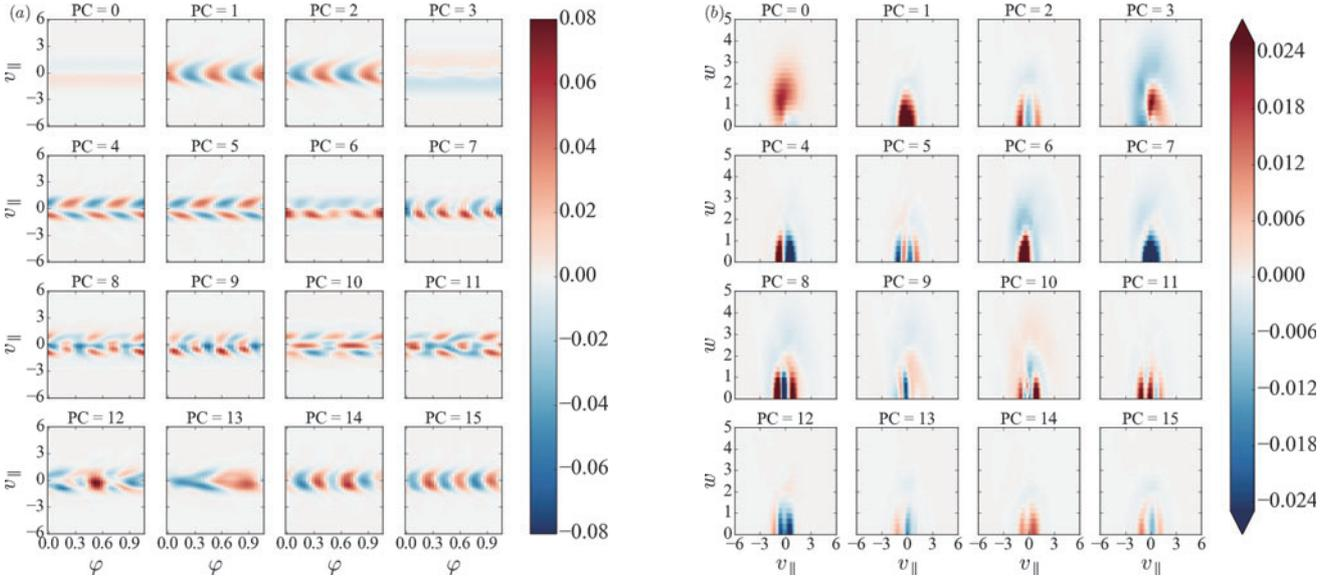
図6 第16主成分までの位相空間基底  $V_k^T(\varphi, v_{\parallel}, w)$  の (a)  $w = 0.12$  断面と (b)  $\varphi = 0$  断面 [7].
