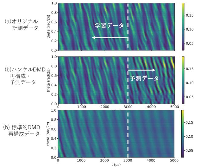
図6 乱流時空間発展の学習と予測：上段から順にオリジナル計測データ、ハンケル・スパース DMD を用いた再構成と予測、標準的 DMD を用いた再構成と予測[40]。  $t < 3000 [\mu\text{s}]$  は学習領域、  $t > 3000 [\mu\text{s}]$  は予測領域。
