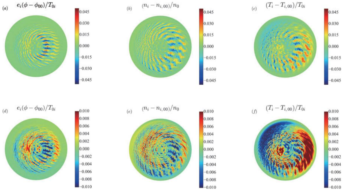
図2 雪崩フェイズ ( $tR_0/v_{ti}=250$ ) における (a) 静電ポテンシャル  $\phi$ , (b) イオン密度  $\delta n_i$ , (c) イオン温度  $\delta T_i$  と静的フェイズ ( $tR_0/v_{ti}=320$ ) における (d) 静電ポテンシャル  $\phi$ , (e) イオン密度  $\delta n_i$ , (f) イオン温度  $\delta T_i$  のポロイダル断面図 [7].
