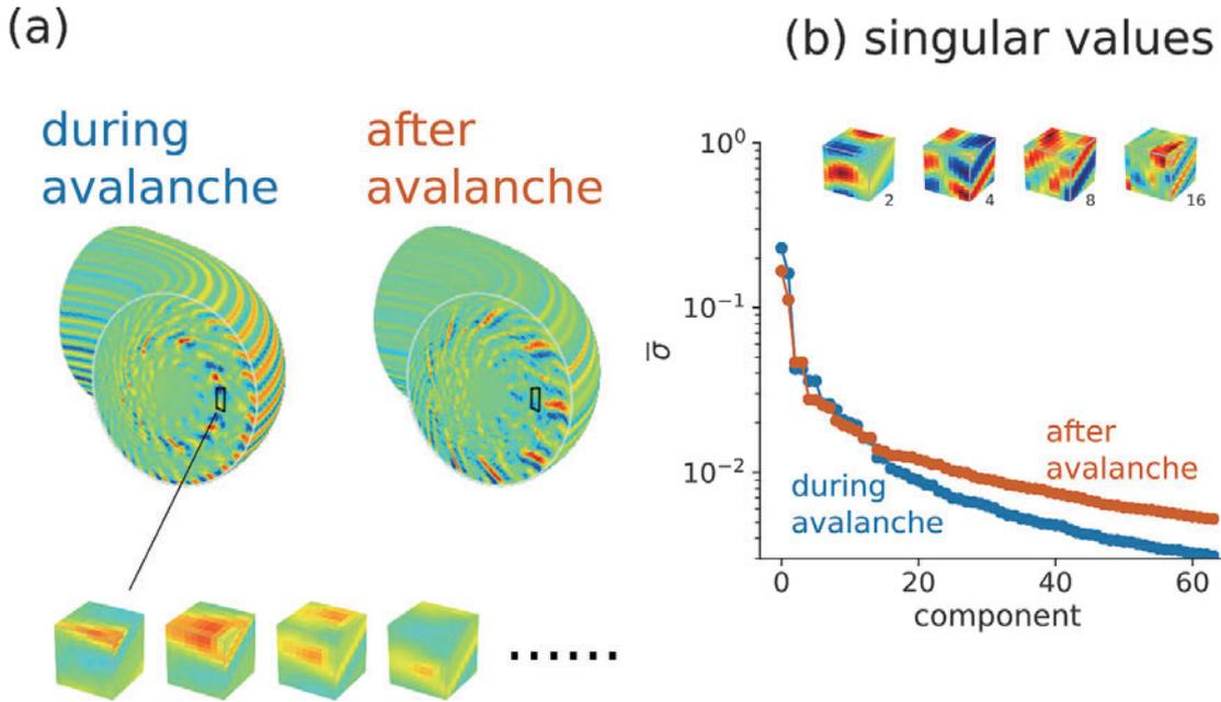
図3 (a)突発的輸送現象がおこっている時およびその直後におけるプラズマ密度ゆらぎの分布. この3次元データから複数の小さな密領域を取得したのち, 特異値分解を適用する. (b)突発的輸送現象の最中およびその直後のデータから得た特異値の分布. 輸送現象の最中では特異値の分布がより尖っている(よりコヒーレント)であるのに対し, 直後では特異値の分布がより平坦(より乱雑)である. 挿入図で, SVDで得られた基底の典型的なものを示す.
