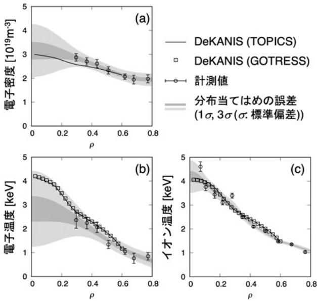
図3 テスト用のJT-60UHモードプラズマに対する(a)電子密度及び(b)電子・(c)イオン温度のDeKANISによる予測と計測値の比較。温度の予測には統合コードTOPICSとGOTRESSを用いた2種の結果を示す。
