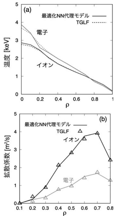
図5 GOTRESSによって行われた、JT-60U Hモードプラズマに対するNN代理モデルとTGLFによる(a)温度と(b)拡散係数の定常分布の予測。
