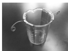
図2 電圧計の外観(この中に図3に示す回転振子をつるす).
