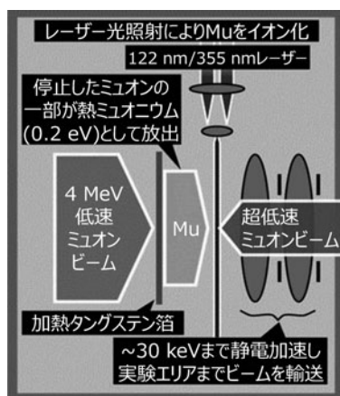
図 1 超低速ミュオン生成プロセスの概念図。
