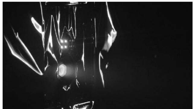
図2 「ほどよし4号」に搭載された小型イオンエンジンの作動の様子。イオン源(下部の発光)の直径は2 cm 程度となっており、小型化している。なお、上部の4つの発光はイオンを中和するための電子を放出するための中和器の発光である。
