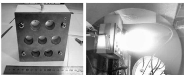
(a) 試作機（放電室7個） (b) 真ん中の放電室にて作動
