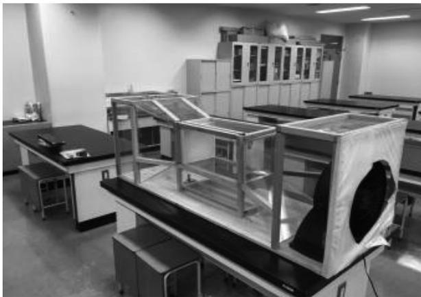
図5 風洞機 ※風速 3.1 m/s.
