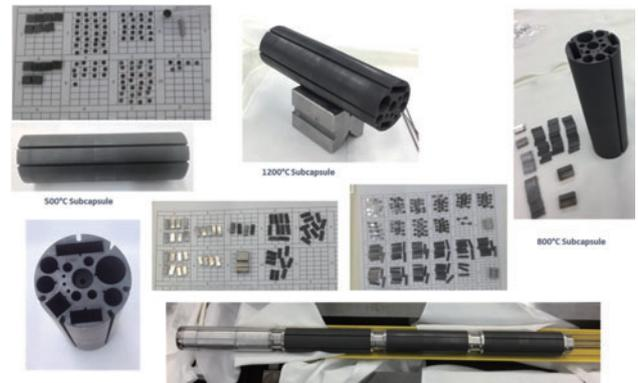
図3 RB19J キャプセルの試料とグラファイトホルダー。
