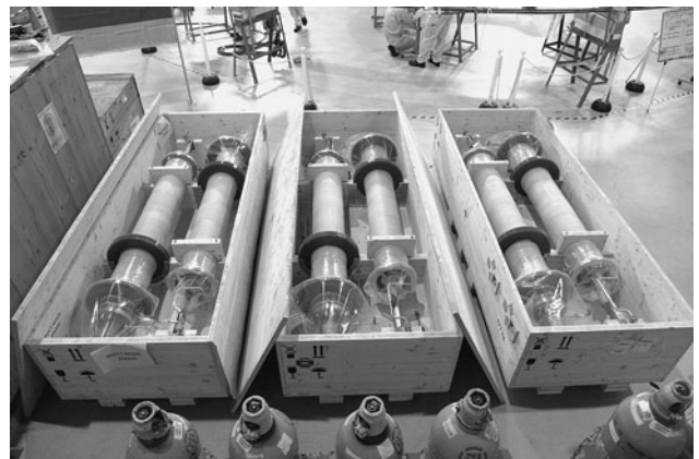
図5 TFC用高温超伝導電流・リードが完納。
