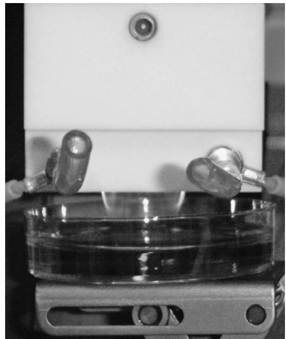
図1 プラズマ活性溶液の作製。 名古屋大学プラズマナノ工学研究センターにより開発された高電子密度大気圧プラズマ発生装置を用いて培養液にプラズマ照射した。
