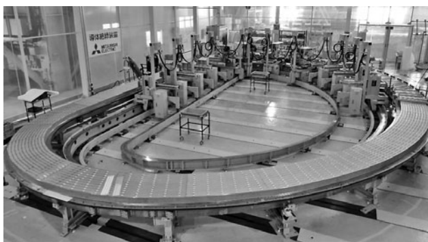
図4 トランスファ及び導体絶縁作業を完了したTFコイル第1号機用の巻線。
