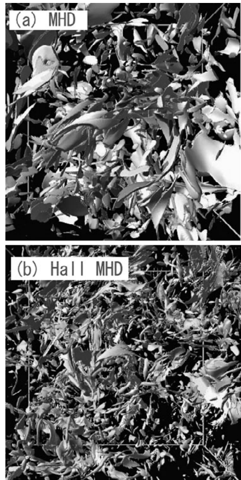
図2 (a)MHD, (b)Hall MHDの電流密度 (薄い灰色), エンストロフィー密度 (濃い灰色) の等値面。閾値は平均値に標準偏差の 4 倍を加えて決定した。
