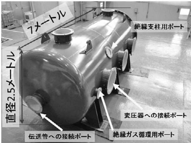
図3 20万ボルト整流器用圧力容器の完成。
