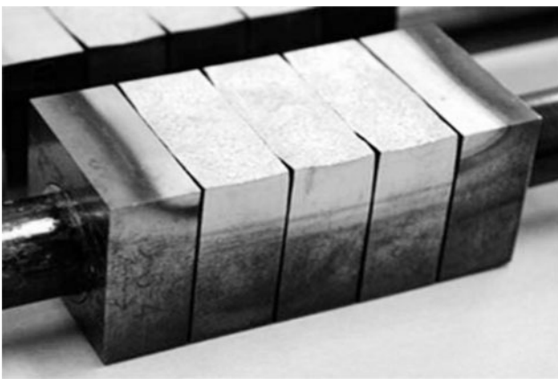
図1 高熱負荷試験後の小型ダイバータ試験体で観測されたタングステンアーマ材の塑性変形（高熱負荷試験では中央の3枚のアーマ材表面を電子ビームで繰り返し加熱した。エッジ部分が湾曲し、隣同士のアーマ材が接触していますが、目視可能な亀裂等は観察されませんでした）。
