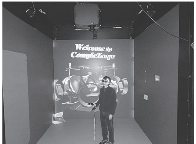
図3 CompleXcopeの全景。利用者は液晶シャッター眼鏡を掛け、ワンドを持っている。前面、左右面、床面がスクリーンになっており、スクリーンは一辺約3メートル。
