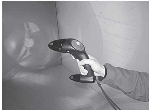
図2 ワンド。操作者はこのワンドを使ってVR空間内の移動、様々な操作などを行える。
