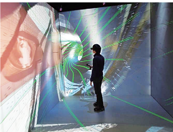
図4 LHD真空容器内にHINT2コードによるプラズマ平衡のデータをVR可視化した様子。
