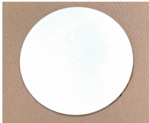
図5 沈殿堆積法で作られた蛍光面付 ITO ガラスの写真。
