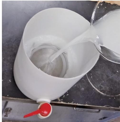
図4 P45 蛍光体溶液をドレンコック付ポリ容器内へと流し込んでいる様子。
