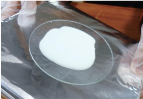
図2 平板を傾斜回転させながら溶液を延ばしている様子。
