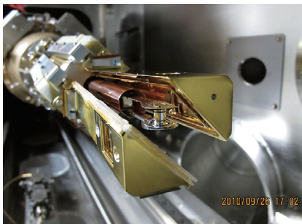
図4 2010年9月29日に使用した低温固化燃料層ターゲットの写真(左)とNIFターゲットチャンバーでのショット直前の写真(右)。
