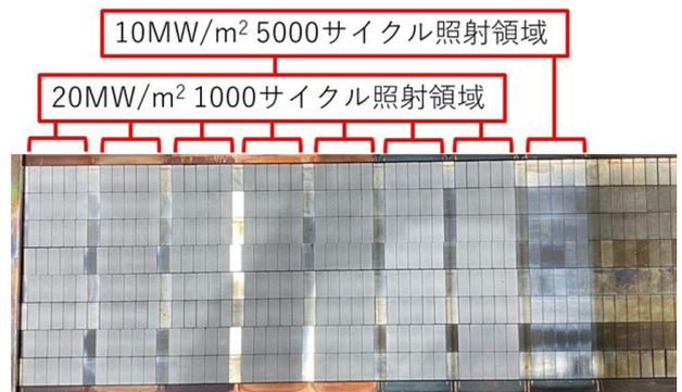
図6 PFU直線部における高熱負荷試験10 MW/m<sup>2</sup> 5000 サイクル及び20 MW/m<sup>2</sup> 300 サイクル後の写真.
