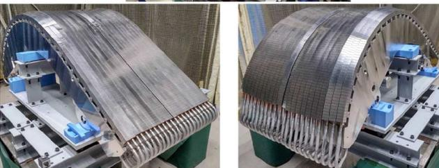
図2 完成したITER外側垂直ターゲット（OVT）実規模プロトタイプ。
