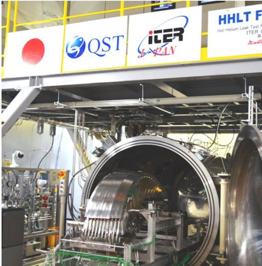
図4 高温リーク試験装置の真空容器内への設置準備をしているITERダイバータ外側垂直ターゲット・プロトタイプ。
