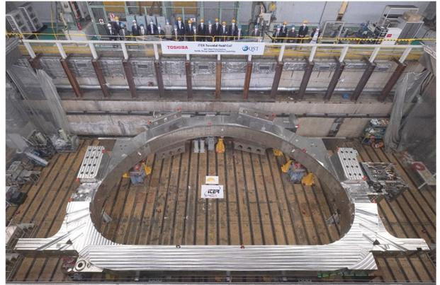
図1 東芝エネルギーシステムズ(株)が製作したTFコイル初号機 (同社提供)。
