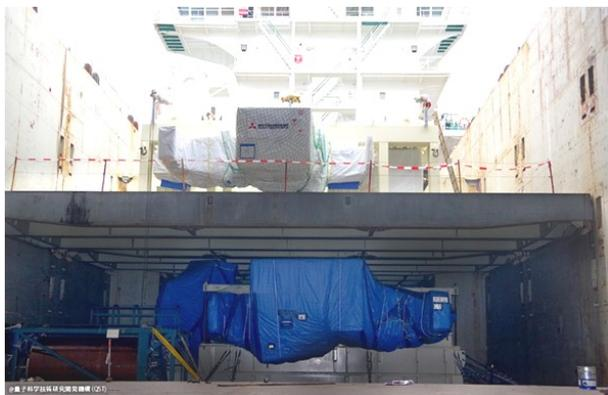
図1 在来船積み込み後のTFコイル。上段が三菱重工製、下段が東芝エネルギーシステムズ製のTFコイル。
