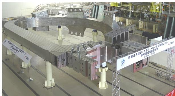
図 1 完成後のトロイダル磁場コイル初号機。
