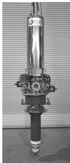
図2 ジャイロトン実機: 8機中、2機分の製作を完了。
