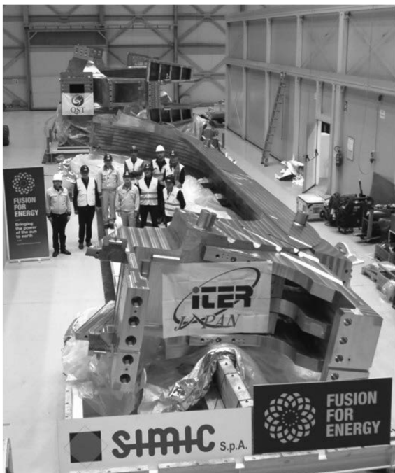
図1 イタリアの一体化工場への搬入を完了した欧州向けTFコイル構造物第1号機(手前はAU, 奥はBU)。
