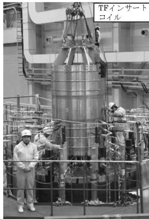
図2 TFインサートコイルの試験装置への組込みの様子。
